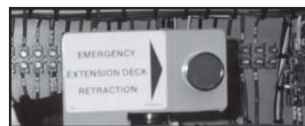
Abbildung 2-24. Noteinfahrer der hydraulischen Plattformverlängerung
